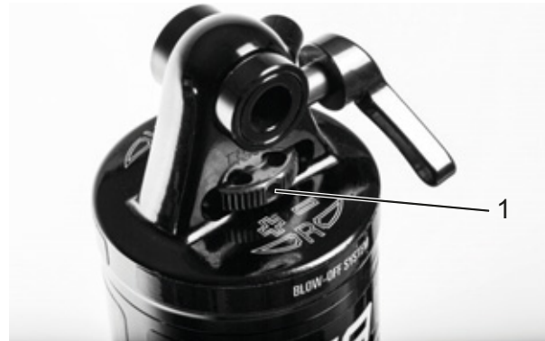
Rysunek 51: Nastawnik odbicia koła Suntour (1) na tylnym amortyzatorze
