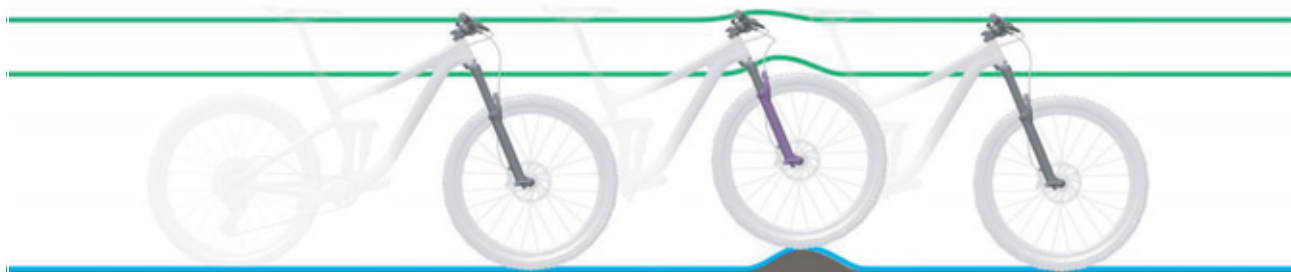
Rysunek 7: Optymalne działanie widelca podczas jazdy po nierównościach
