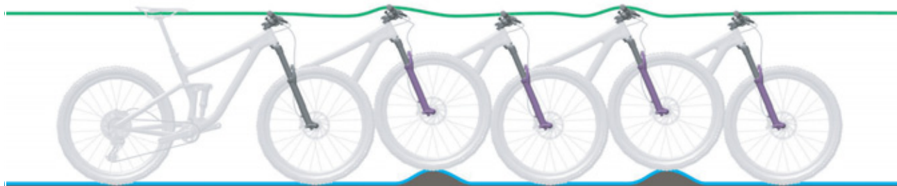
Rysunek 5: Optymalne działanie widelca
