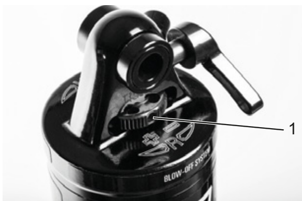
Rysunek 81: Obracanie tłumika odbicia w kierunku zgodnym z ruchem wskazówek zegara
