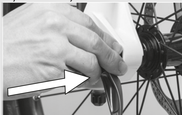
Rysunek 33: Wsuwanie zacisku szybko mocującego
