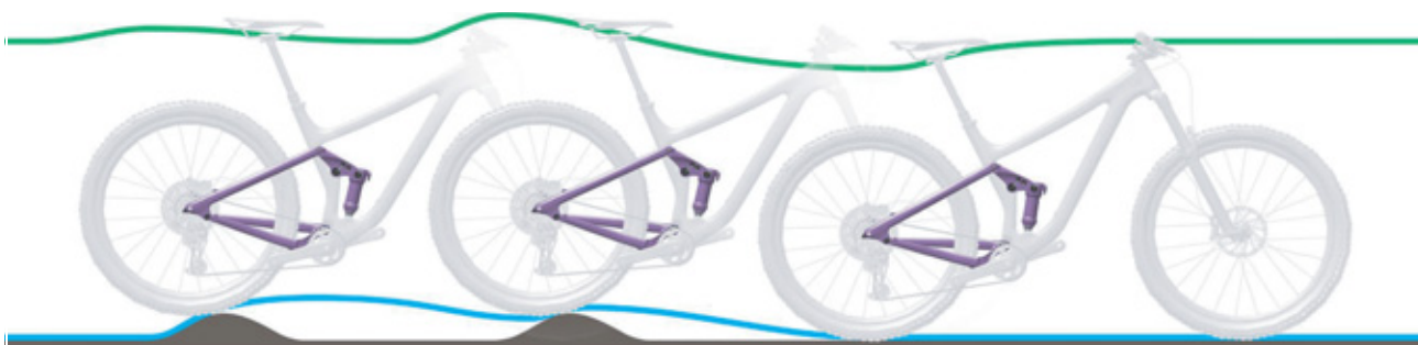
Rysunek 82: Zbyt wolne rozprężanie się tylnego amortyzatora
