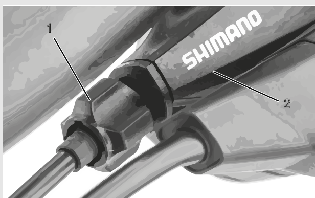
Rysunek 69: Nakrętka regulacyjna (1) jednocięgowego mechanizmu zmiany przerzutek z obudową dźwigni zmiany biegów (2), przykład
