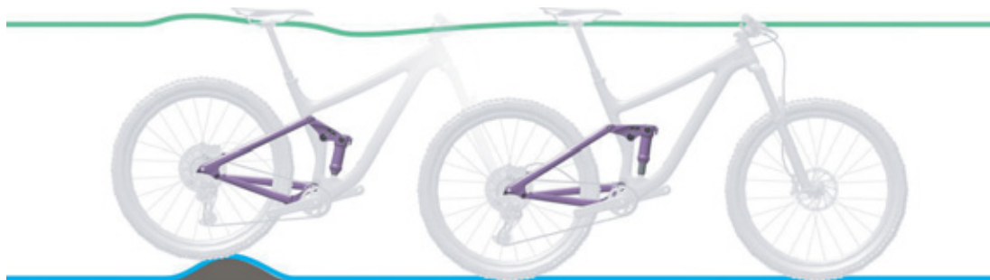
Rysunek 12: Optymalne działanie tylnego amortyzatora na nierównościach
