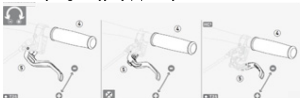
Rysunek 43: Ustawianie odchylenia manetki dźwigni hamulca tarczowego Magura
