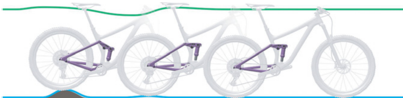
Rysunek 80: Zbyt szybkie rozprężanie się tylnego amortyzatora
