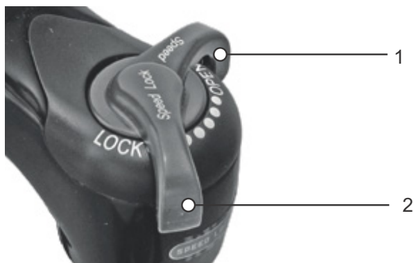
Rysunek 64: Tłumik dobicia Suntour w otwartej (1) i zamkniętej (2) pozycji
