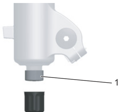
Rysunek 52: Nastawnik odbicia FOX (1) na zabezpieczeniu widełca przed wypadnięciem
