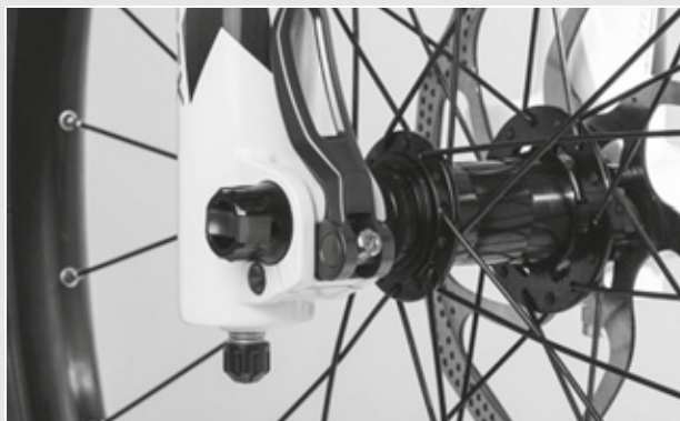
Rysunek 67: Ustawianie siły mocowania zacisku szybkomocującego
