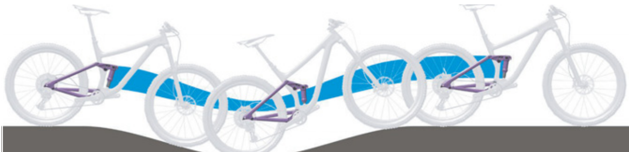
Rysunek 84: Zbyt miękkie amortyzowanie tylnego amortyzatora na wzniesieniu
