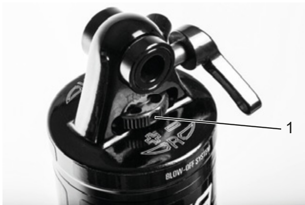
Rysunek 83: Obracanie tłumika odbicia ruchem przeciwnym do ruchu wskazówek zegara
