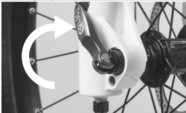
Rysunek 35: Zamykanie zacisku szybko mocującego
