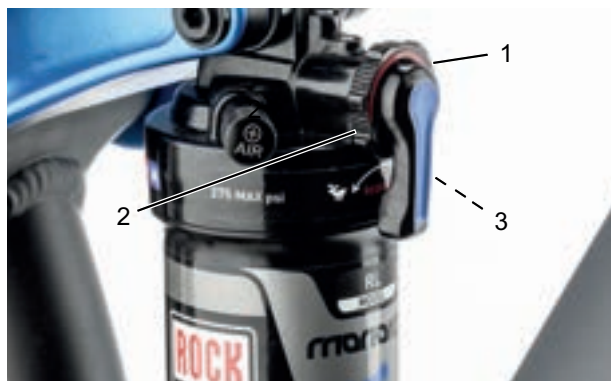
Abbildung 78: Härte des Zugstufen-Dämpfers am Einstellrad (1) des Hinterbau-Dämpfers einstellen
