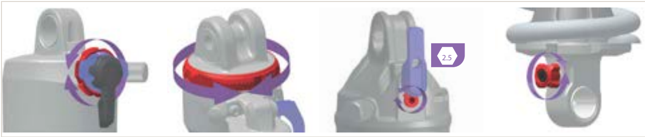
Afbeelding 176: Locatie en vorm van de trekdemperafsteller (achterbouwdemper) is afhankelijk van het model. Trekdemperafstellers zijn altijd rood
