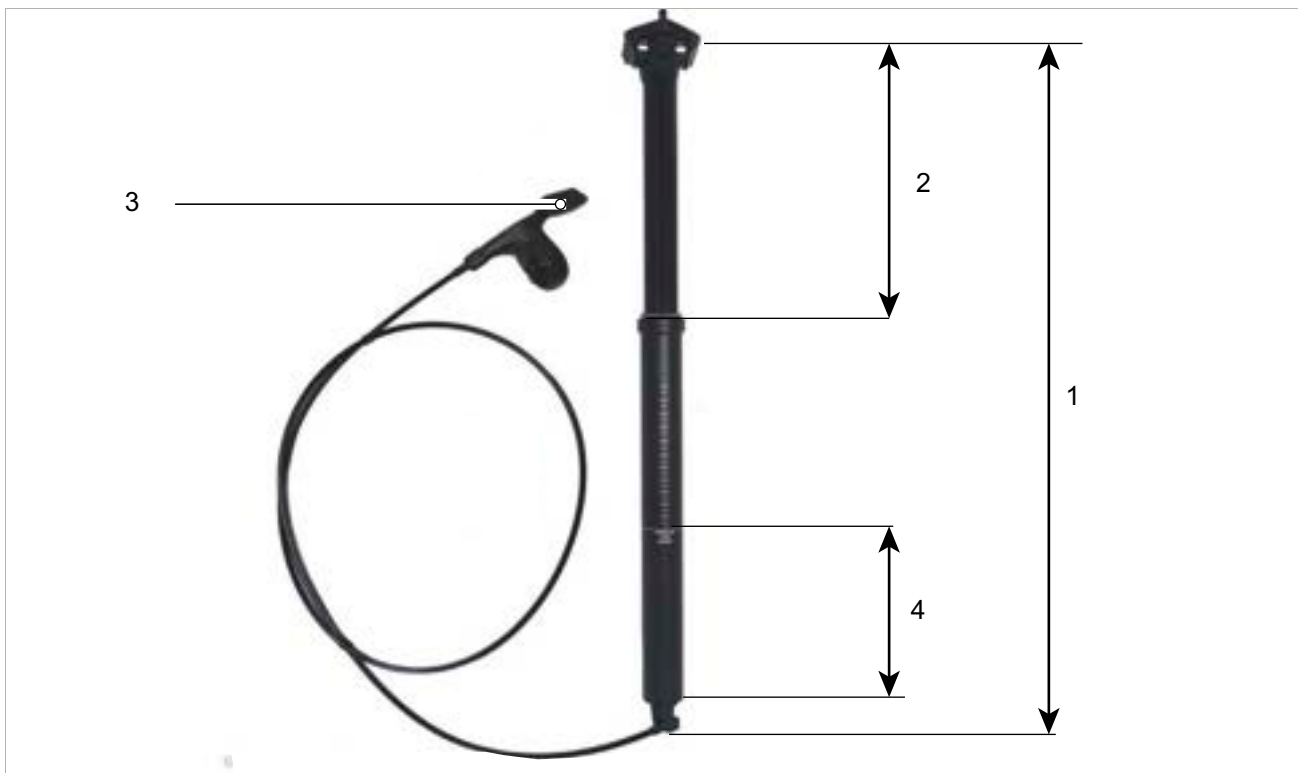
Afbeelding 44: Opbouw en afmetingen van de zadelpen LIMOTEC A1
