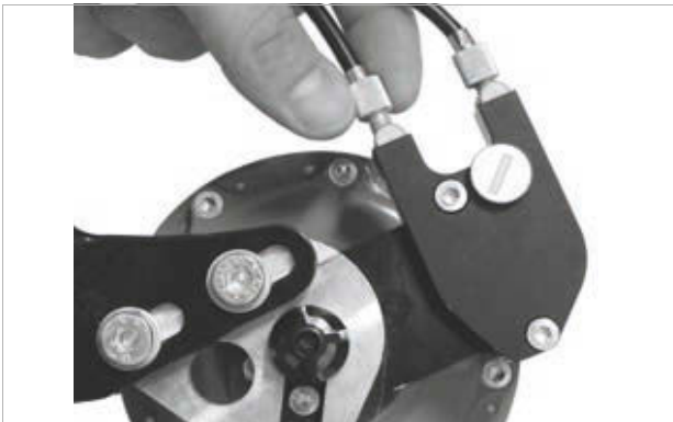
Afbeelding 240: Bij ROHLOFF naafversies met externe schakelaansturing zit de kabelafsteller op de kabelbox aan de linkerkant
