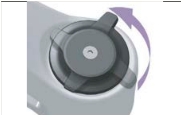
Afbeelding 316: Drukdemperafsteller zachter afstellen
