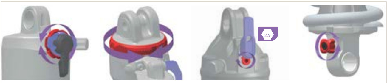
Afbeelding 324: Locatie en vorm van de trekdemperafsteller (achterbouwdeemper) (rood) zijn afhankelijk van het model
