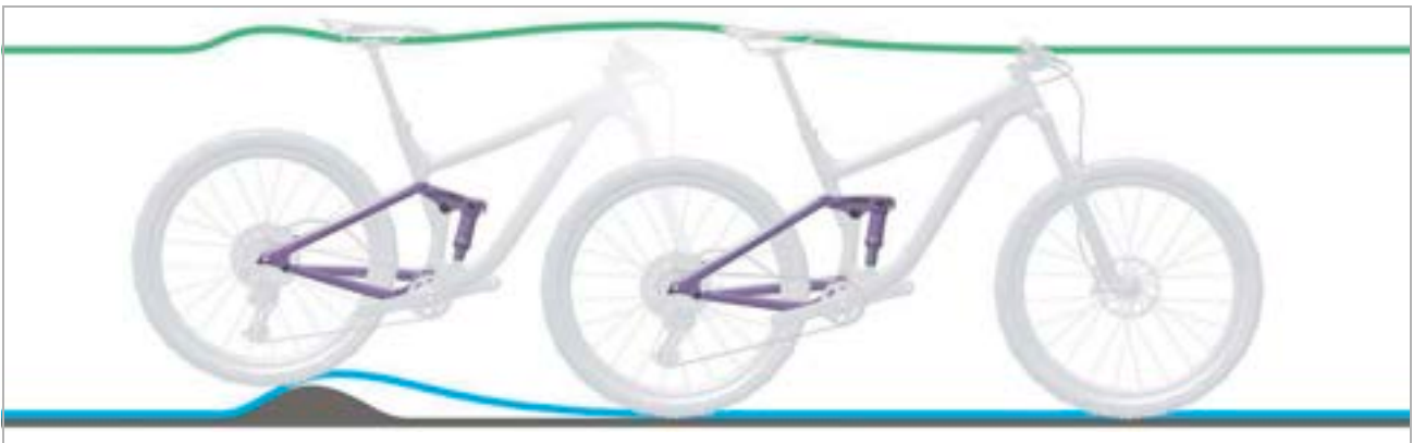
Afbeelding 337: Te harde demping van de achterbouwdemper bij oneffenheden
