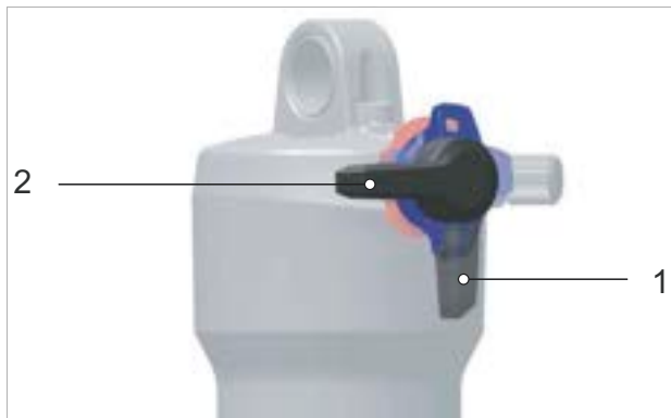
Afbeelding 185: Open stand (1) en stand van de drempel (2) op de achterbouwdemper (zwart)
