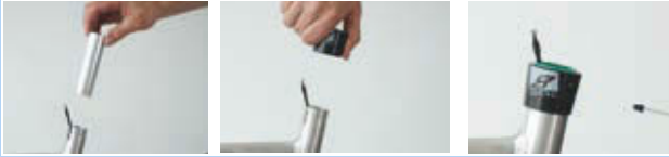
Afbeelding 303: Glijbus en buitenhuls monteren
