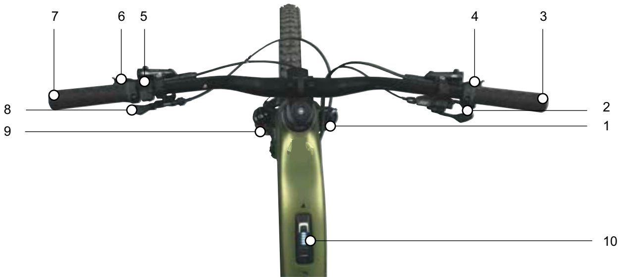
Afbeelding 60: Detailaanzicht stuur met boordcomputer BOSCH System Controller en bediening Mini Remote, voorbeeld
