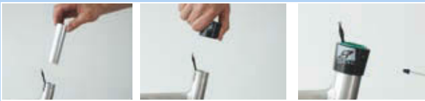
Afbeelding 270: Glijbus en buitenhuls monteren
