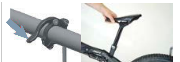
Afbeelding 122: Hydraulische gasveer uitschuiven
