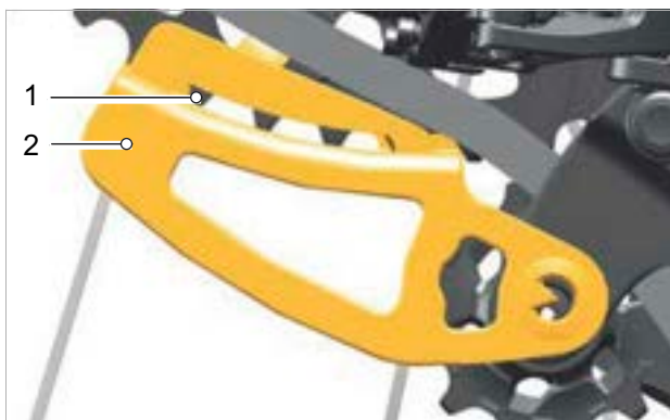
Afbeelding 154: Vensteruitsnede (1) met tanden in de chain gap-kaliber (2)
