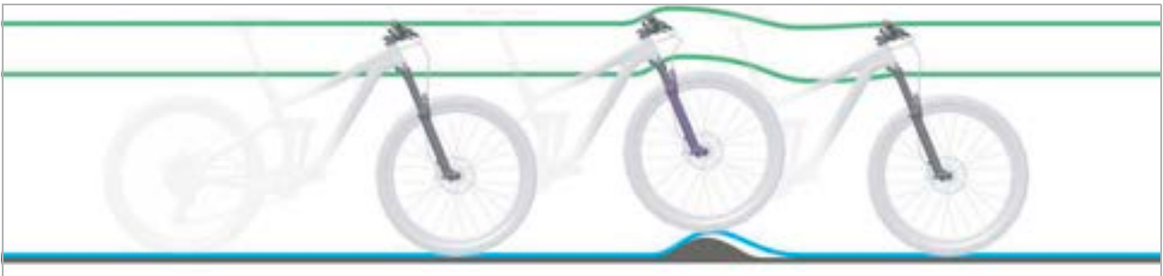
Afbeelding 322: Te harde demping de verende voorvork bij oneffenheden
