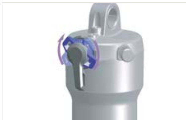
Afbeelding 186: Drukdemperafsteller harder afstellen
