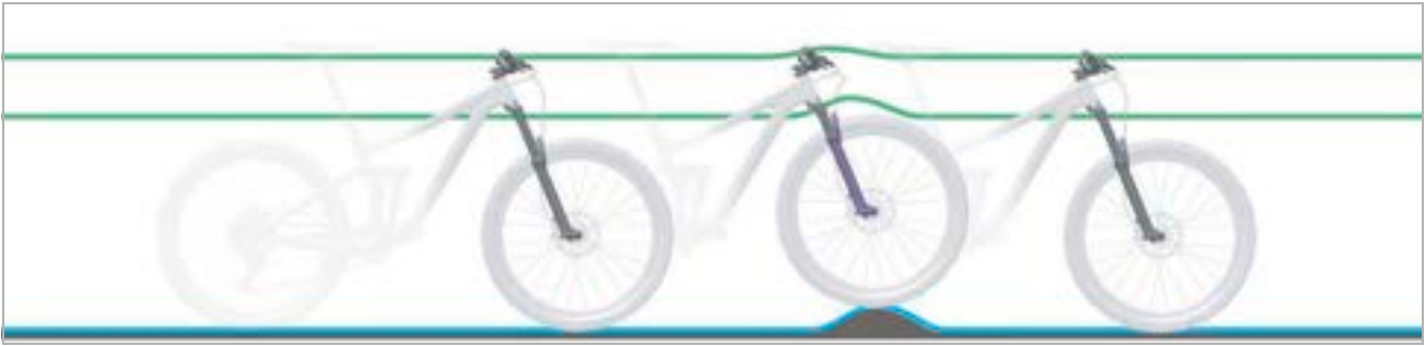
Afbeelding 23: Optimaal rijgedrag van de verende voorvork bij oneffenheden
