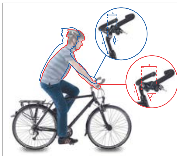
Afbeelding 141: Stadsfiets- (blauw) en toerfietsstand (rood) door verandering van de hoek
