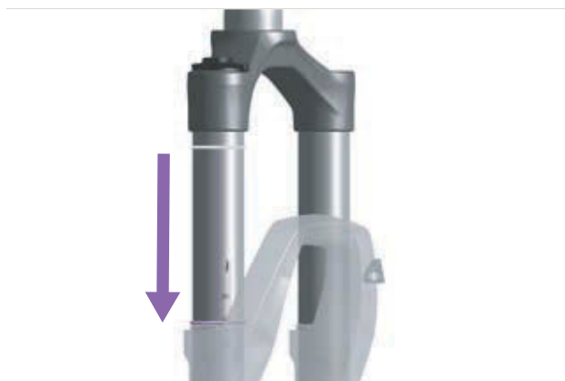
Afbeelding 168: O-ring op de verende voorvork verschuiven
