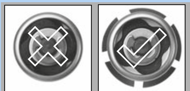
Afbeelding 99: Gesloten en geopende flens
