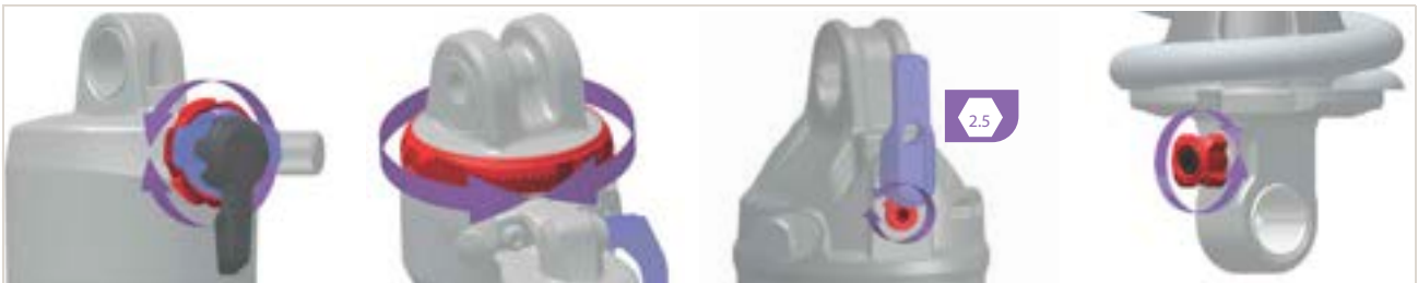
Afbeelding 326: Locatie en vorm van de trekdemperafsteller (rood) zijn afhankelijk van het model
