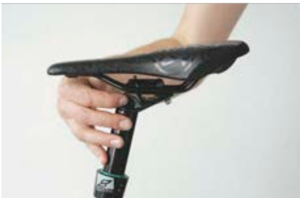
Afbeelding 131: Zadelhoek afstellen met het instelwiel
