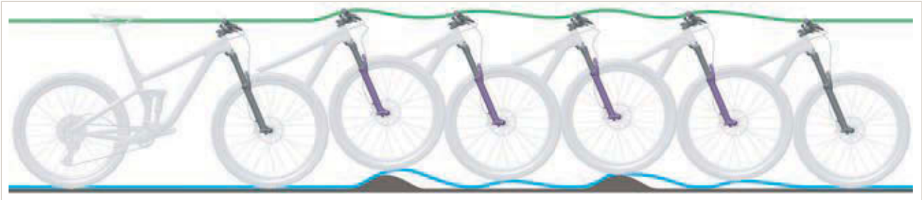
Afbeelding 309: Te snel uitveren van de verende voorvork
