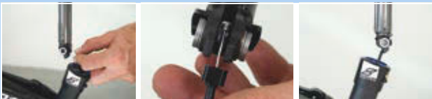
Afbeelding 304: Zadelpen ophangen en inschuiven
