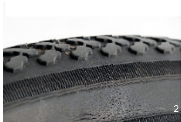
Afbeelding 185: Voorbeelden van vermoeiingsscheuren (1) en verouderingsscheuren (2)
