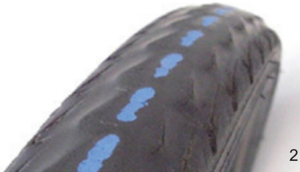
Afbeelding 184: Een band zonder profiel, die kan worden vervangen (1) en een band met zichtbare lekbescherming (2), die moet worden vervangen
