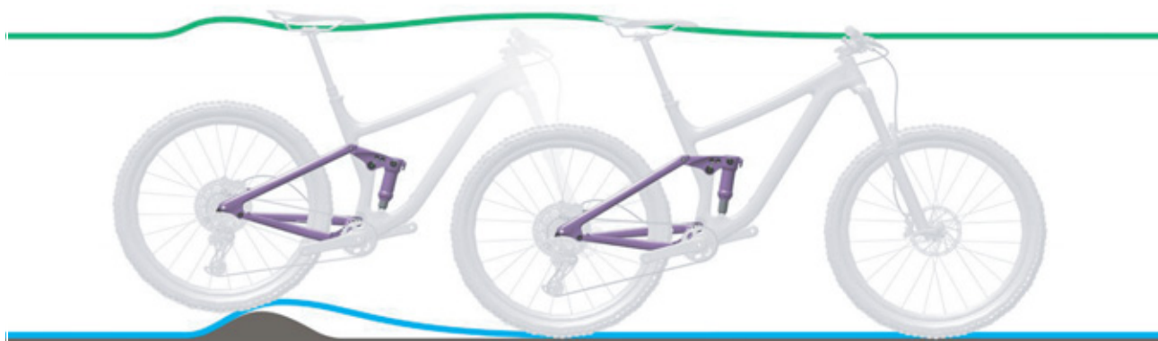
Afbeelding 230: Te harde demping van de achterbouwdemper bij oneffenheden
