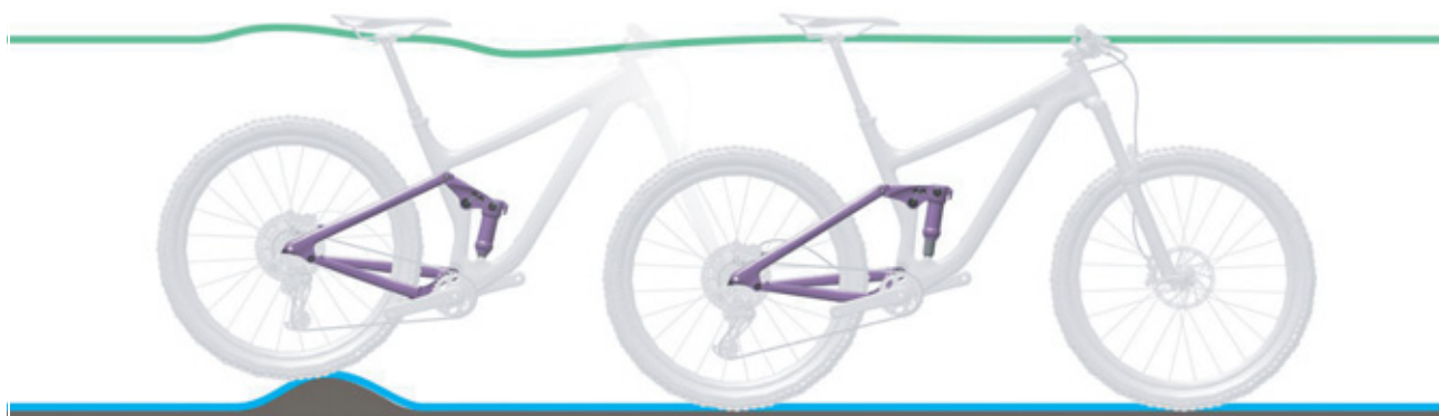
Afbeelding 164: Optimaal rijgedrag van de achterbouwdemper bij oneffenheden
