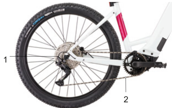
Afbeelding 45: Schema kettingaandrijving met derailleur
