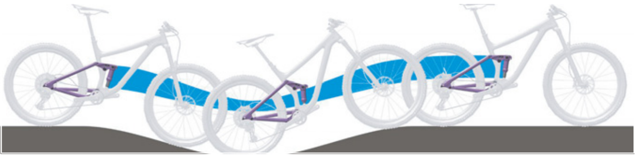
Afbeelding 228: Te zachte vering van de achterbouwdemper bij kuilen
