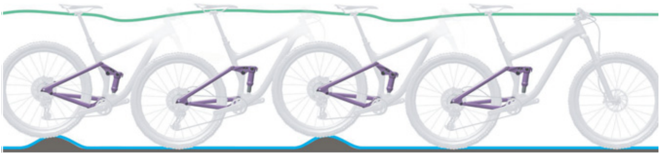
Afbeelding 5: Optimaal rijgedrag van de achterbouwdemper
