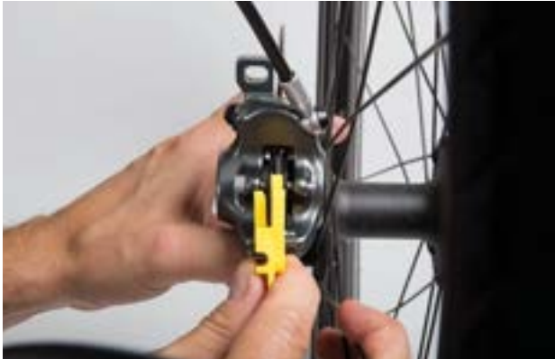
Afbeelding 186: Remvoering in gemonteerde toestand controleren met behulp van de transportbeveiliging
