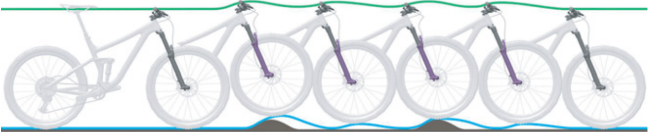
Afbeelding 218: Te snel uitveren van de verende voorvork
