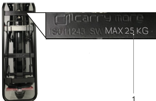
Afbeelding 157: Op de bagagedrager staat het maximale draagvermogen (1) vermeld
