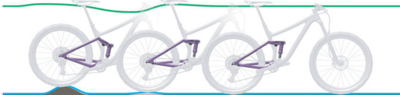
Afbeelding 224: Te snel uitveren van de achterbouwdeemper
