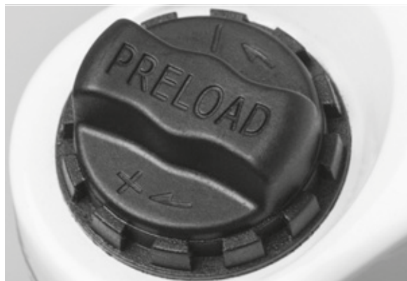
Afbeelding 29: Afstelwiel voor de negatieve veerweg op de kroon van de verende voorvork
