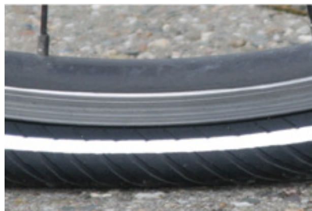
Figura 101: Pressione di gonfiaggio insufficiente
