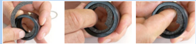
Figura 205: Applicazione dell'anello di feltro
