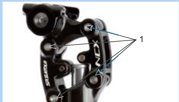
Figura 156: Punti di lubrificazione del cannotto reggisella ammortizzato SR Suntour
