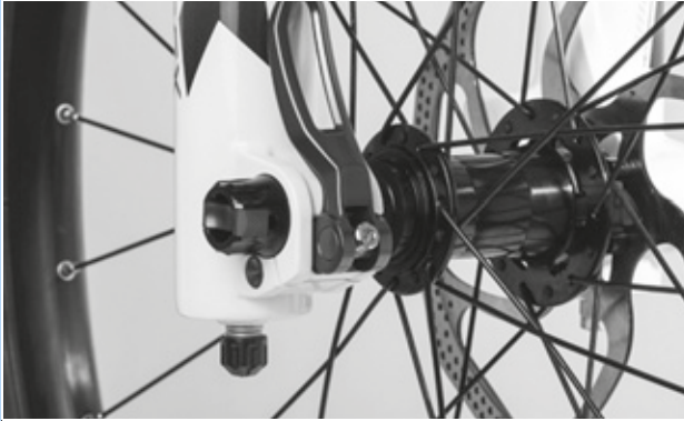
Figura 154: Regolazione della forza di serraggio del bloccaggio rapido
