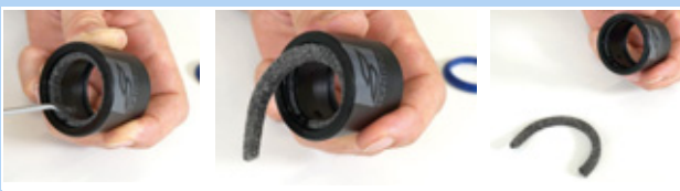
Figura 203: Rimozione dell'anello di feltro
