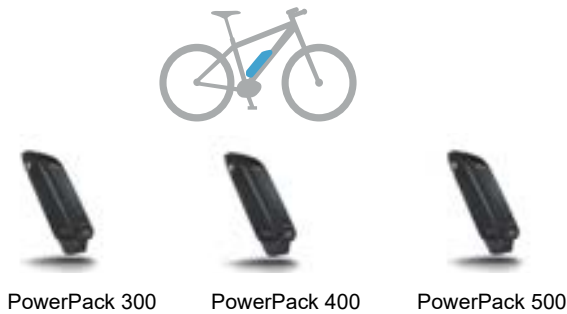
Figura 29: Panoramica batteria sul tubo trasversale
