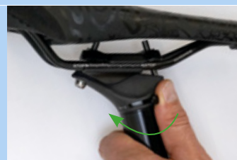
Figura 213: Chiusura della regolazione in altezza
