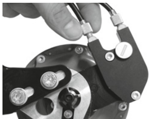
Figura 150: Le versioni del mozzo Rohloff con comando esterno del cambio hanno i regolatori del tensionamento sulla scatola dei cavi situata sul lato sinistro
