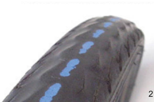
Figura 144: Pneumatico senza profilo ancora utilizzabile (1) e pneumatico con protezione contro le forature in vista (2) che deve essere sostituito
