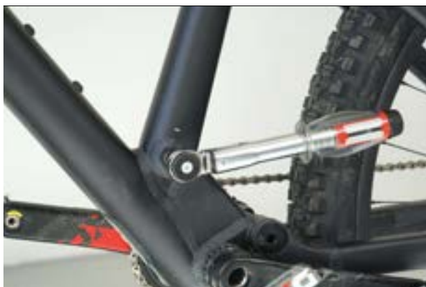
Figura 84: Serraggio dell'asse del canotto reggisella
