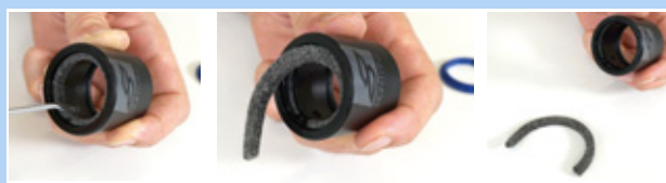
Figura 168: Rimozione dell'anello di feltro
