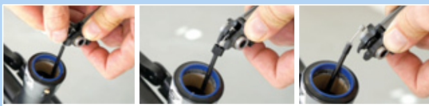
Figura 198: Rimozione del cavo meccanico
