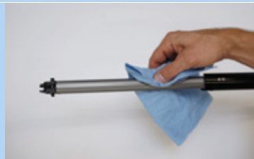
Figura 210: Pulizia della scanalatura di guida longitudinale
