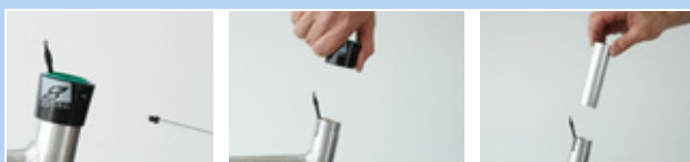
Figura 165: Smontaggio della boccola esterna e del manicotto scorrevole
