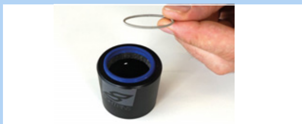
Figura 166: Anello elastico smontato
