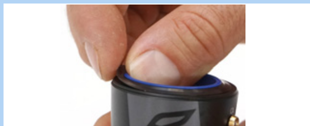
Figura 200: Estrazione dell'anello a labbro di tenuta
