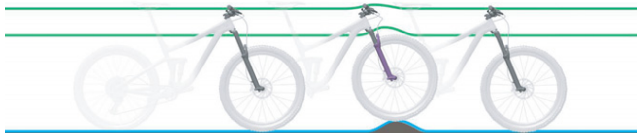
Figura 134: Comportamento di marcia ottimale su un terreno con asperità
