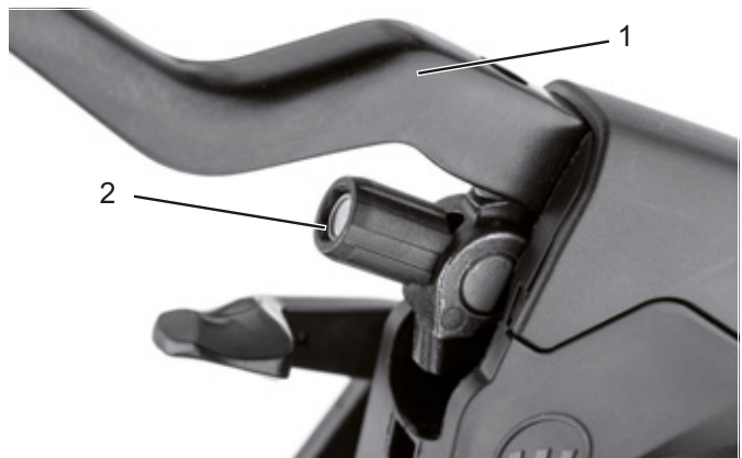
Figura 81: Leva del freno (1) del freno a pattino ad azionamento idraulico con vite di regolazione (2)
