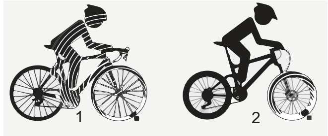
Figura 5: Bicicletta senza sospensione (1) e con sospensione (2) nel passaggio su un ostacolo
